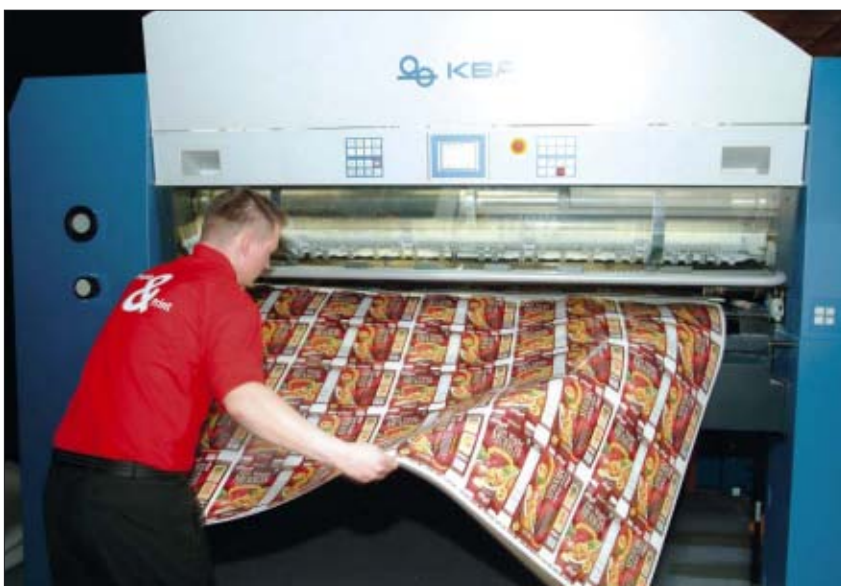
Pohled, který potěší každého tiskaře: 25 obalů pro cereálie na jediném archu formátu XXLplus
